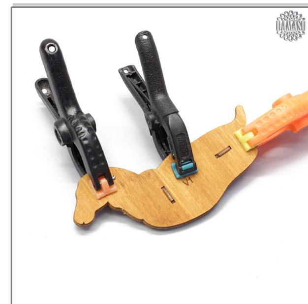
Die äußenen vier Schichten bilden dabei die Beine des Tieres. Prüfen Sie beim Anleimen dieser Schichten den korrekten Stand des Hirsches. Sie können dazu die Schichten trotz der mittleren Führung etwas schieben.
