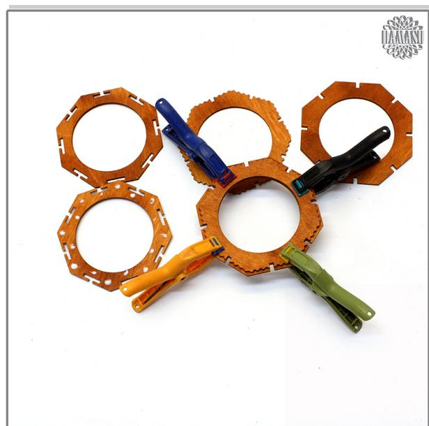
Leimen Sie den gezackten Ring auf den größten Ring und danach den kleinsten Ring auf den gezackten Ring. Die drei Ringe müssen sehr exakt übereinandergeleimt werden. Zum Trocknen können die Ringe mit solchen Bastelklammern oder Wäscheklammern zusammengeheftet werden. Haben Sie keine Klammer zur Hand, dann können Sie die Ringe auch einfach mit irgendetwas beschweren.
