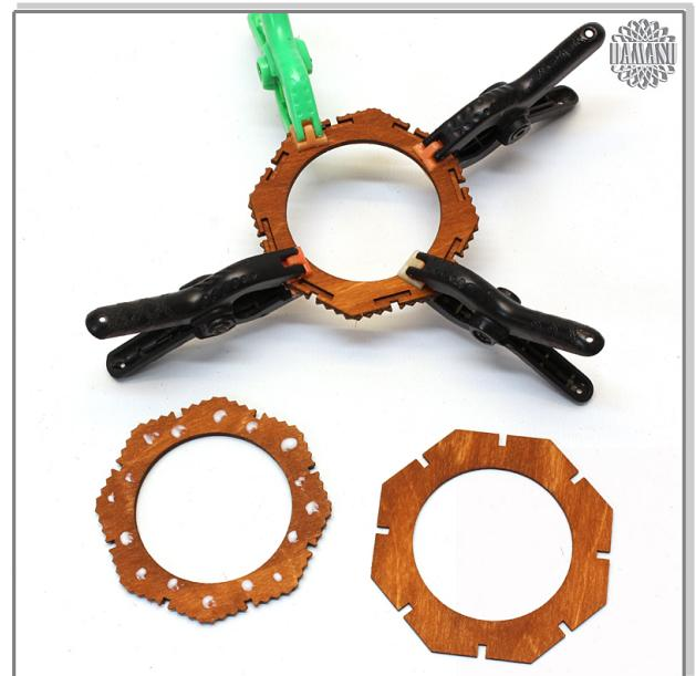
Bei dem großen Turmsegment hat jedes Seitenteil mehrere Durchbrüche. Diese geben vor, wo oben und unten ist. Unten ist da, wo die beiden kleinen viereckigen Löcher sind. Setzen Sie das Turmsegment so zusammen, dass alle Seitenteile gleich ausgerichtet sind.
