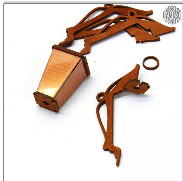
Im nächsten Arbeitsschritt werden die Seitenteile an den Beleuchtungskörper geleimt. Dazu leimen Sie zuerst das dritte Verbindungsstück oben an eines der Seitenteile an. Lassen Sie diese Leimverbindung gut trocknen.
