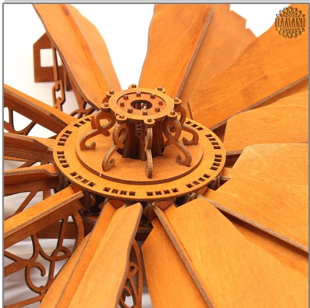
Verschließen Sie die Nabe mit zwei Keilen. Es gibt zwei Keilgrößen. Probieren Sie aus, welche besser passt. Eventuell müssen Sie auch die Keile etwas zurechtschleifen. Die Keile werden nicht verleimt. So können Sie die Nabe zu Reparaturzwecken jederzeit wieder öffnen.
