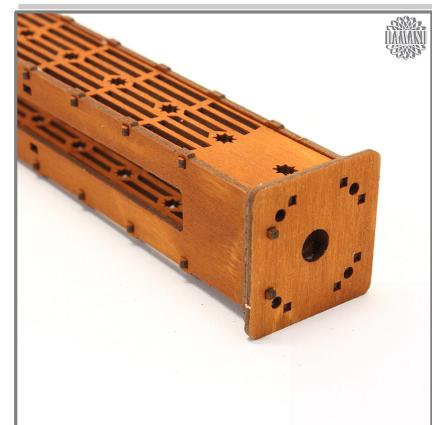
... und dann die beiden Platten der runden Seite. An der Unterseite schauen zwei Zapfen heraus. Diese werden später benötigt für die Positionierung auf der Bodenplatte.
