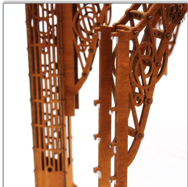
Schieben Sie die Bögen vorsichtig nach unten bis zum Anschlag der Zapfen. Wenn alles korrekt aufgebaut ist, dann sollten alle Säulen auf dem Boden stehen und der Turm sollte gerade stehen. Wenn das nicht der Fall sein sollte, dann schauen Sie bitte, wo der Fehler liegen könnte und korrigieren Sie ihn.
