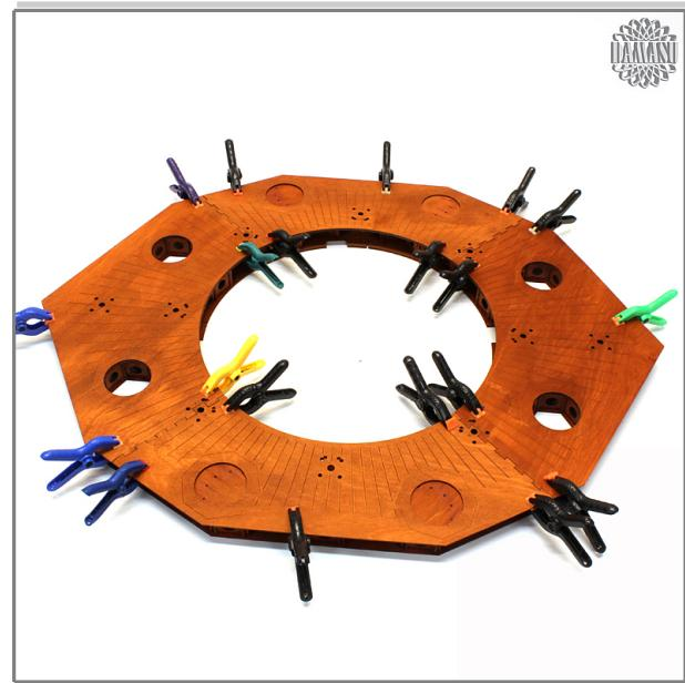
Eine der ausgerichteten Platten nehmen Sie zum Anleimen ab. Die anderen drei Platten bleiben fixiert. Streichen Sie die Strukturplatte mit Leim ein und setzen Sie die Verkleidungsplatte wieder exakt auf. Zum Trocknen wird sie wieder fixiert.
