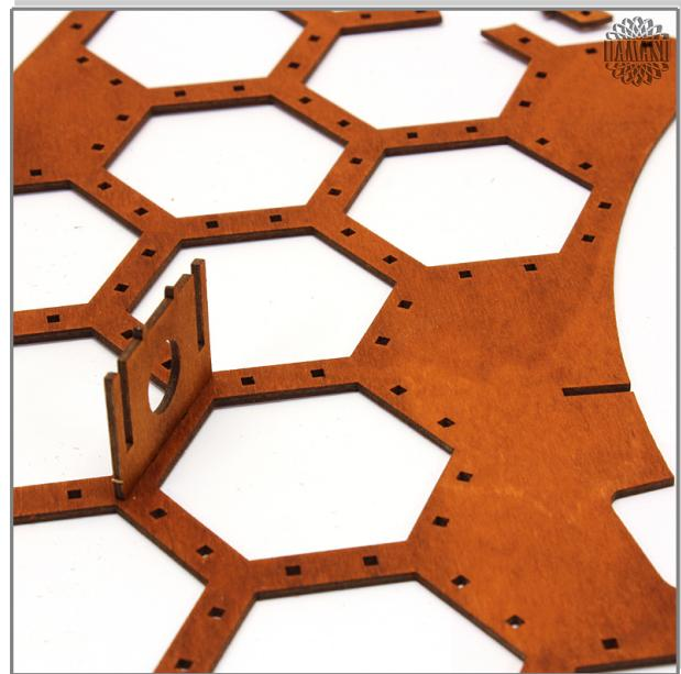
Dann nehmen Sie ein Teil, das auf einer Seite eine H-Nut hat und auf der anderen Seite eine lange Nut. Die H-Nut stecken Sie nun an eine Seite des schon stehenden Teiles. Dabei achten Sie darauf, dass die lange Nut die Öffnung nach oben hat.
